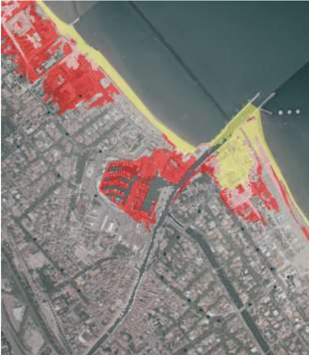
Figura 4: esempio di mappa della pericolosità all'ingressione marina prodotta dalla Regione nell'ambito della "Direttiva Alluvioni" 2007/60/Ce, presso Cesenatico; le aree campite in giallo rappresentano settori ad alta pericolosità (scenari frequenti), in rosa mediamente pericolosi (scenari poco frequenti), in rosso a bassa pericolosità (scenari rari).
