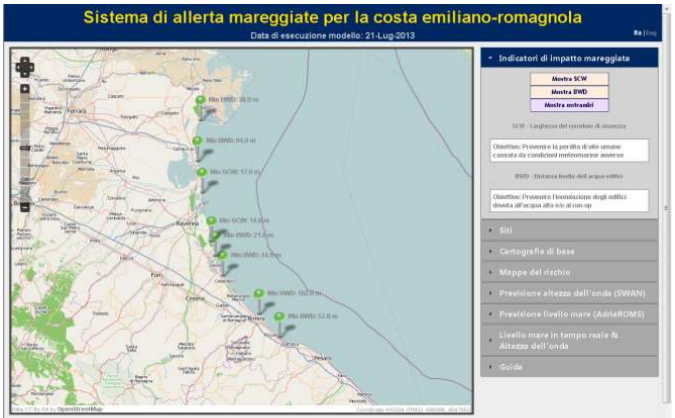
Figura 6: pagina web del sistema di previsione degli impatti prodotti dalle mareggiate; questo sistema opera in catena con i modelli di previsione di onda e di livello del mare gestiti da ARPA-SIMC ed è consultabile on-line al sito http://geo.regione.emilia-romagna.it/schede/micore/ . I “valori soglia” dei parametri meteo-marini da utilizzare nelle procedure di allertamento costiero (EWS) sono stati ricavati dall’analisi statistica delle serie storiche dei dati meteo-marini e dall’analisi delle mareggiate storiche impattanti nel periodo 1946-2010.
